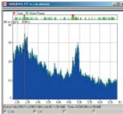
Abb. 3 FFT-Spektrum mit dem Cursor an einem Sinuston bei 2343,8 Hz
